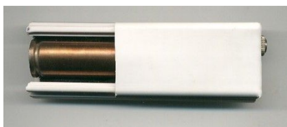
Una sonda con tubo VA-Z-115.1 e una con tubo LND712 con il Geiger Adapter coperto
