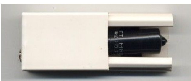
Una sonda con tubo VA-Z-115.1 e una con tubo LND712 con il Geiger Adapter coperto
