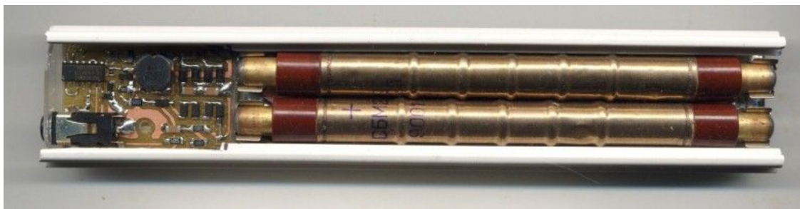
Una sonda con due SBM20, senza coperchi
