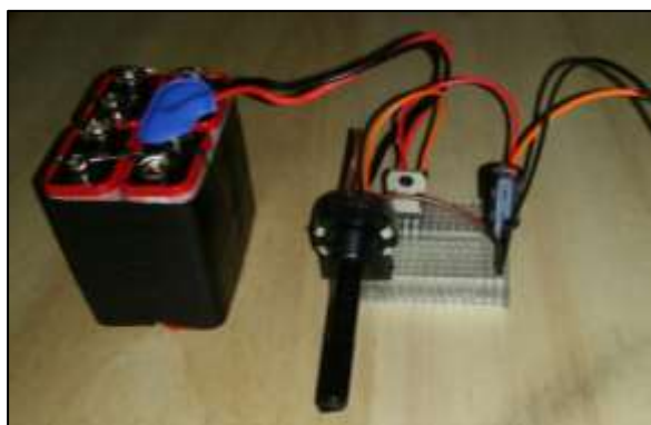
Esempio di generatore 30V a "basso rumore" basato su batterie
