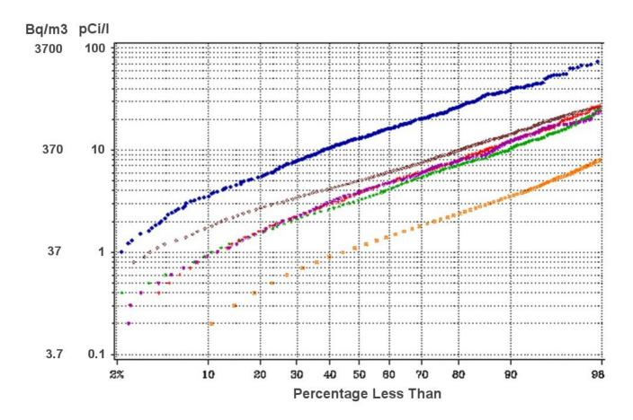
Su un campione di migliaia di casi nessuna misurazione è risultata inferiore ai classici 0.2 pCi/litro (8 Bq/m3) che si misurano all'aperto o ha superato i 70 pCi/litro (2600 Bq/m3)
