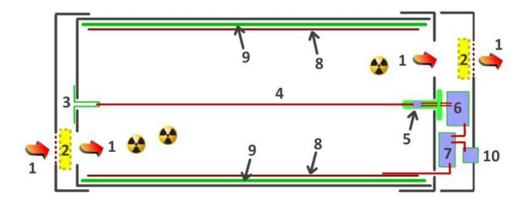
La camera a ioni consiste in un cilindro di 8 cm di diametro a 20 cm di altezza, per un volume totale di un litro e da tre coperchi che proteggono i componenti elettronici dai disturbi elettrici e dalla polvere. Il cilindro e i coperchi (righe di colore nero) sono in lamiera stagnata e sono tutti connessi elettricamente tra loro e uniti meccanicamente con fili di rame saldati a stagno.
