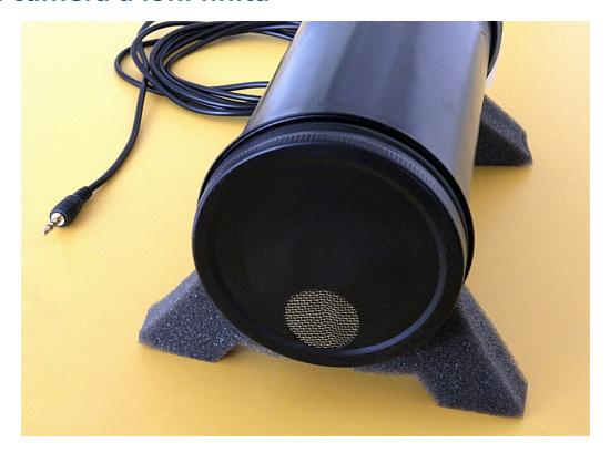
Per chi dovesse cercare letteratura sull'argomento le parole da cercare sono: "Camera a ioni di tipo a diffusione per la misura continua del radon, tramite conteggio, secondo il metodo CR della EPA"
