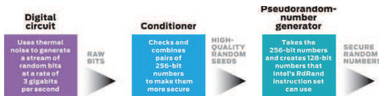
Figura 6: Il generatore di numeri casuali "quantistico" di Intel. (a) Circuito RNG digitale di base. Ad ogni impulso l'uscita si stabilizza nello stato binario casuale. Questo è in effetti ancora un altro generatore di rumore basato su un flip-flop di tipo RS tagliato appositamente preparato i cui ingressi sia set che reset sono legati insieme e guidati allo stesso tempo. La specialità di questo flip-flop è che le sue porte interne possono essere regolate in corrente in modo tale da rendere possibile che l'uscita possa stabilizzarsi in uno stato basso o alto. (Normalmente sarebbe bloccato su uno stato o produrrebbe un bias elevato a causa della più piccola asimmetria delle sue porte interne). (b) Lo schema di post-elaborazione.
