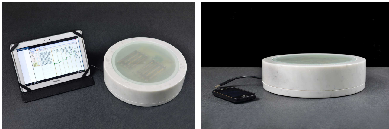
Fig. 13 – Prototipo di misuratore di contaminazione dei cibi: "Geiger OSA 14 Marble Carrara - Frediani"
