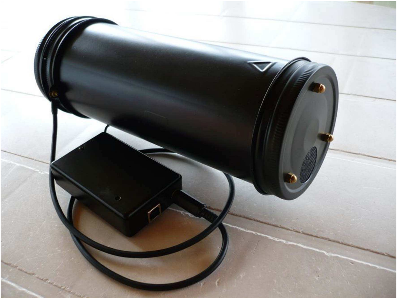
Fig. 9 – Camera a ioni realizzata dal sig. Luciano Orsetti, collaboratore dell'Osservatorio
