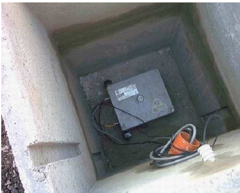
Fig. 3 – Il pozzetto e l’acquisitore della stazione IESN di Maratea (PZ)
