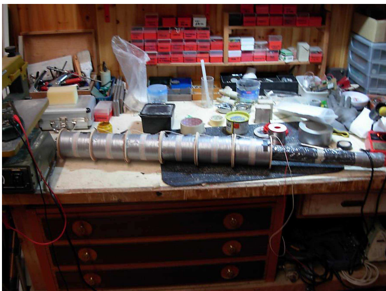
Fig. 20 – Prototipo di antenna con nucleo in barrette di ferro dolce in fase di montaggio
