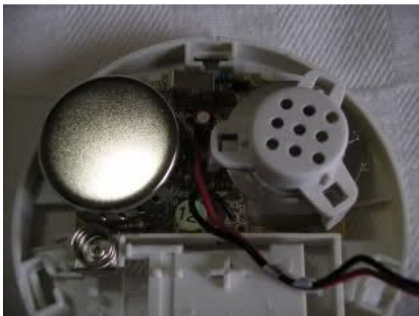
A sinistra la camera ionizzazione che protegge l'accesso alla sorgente radioattiva
