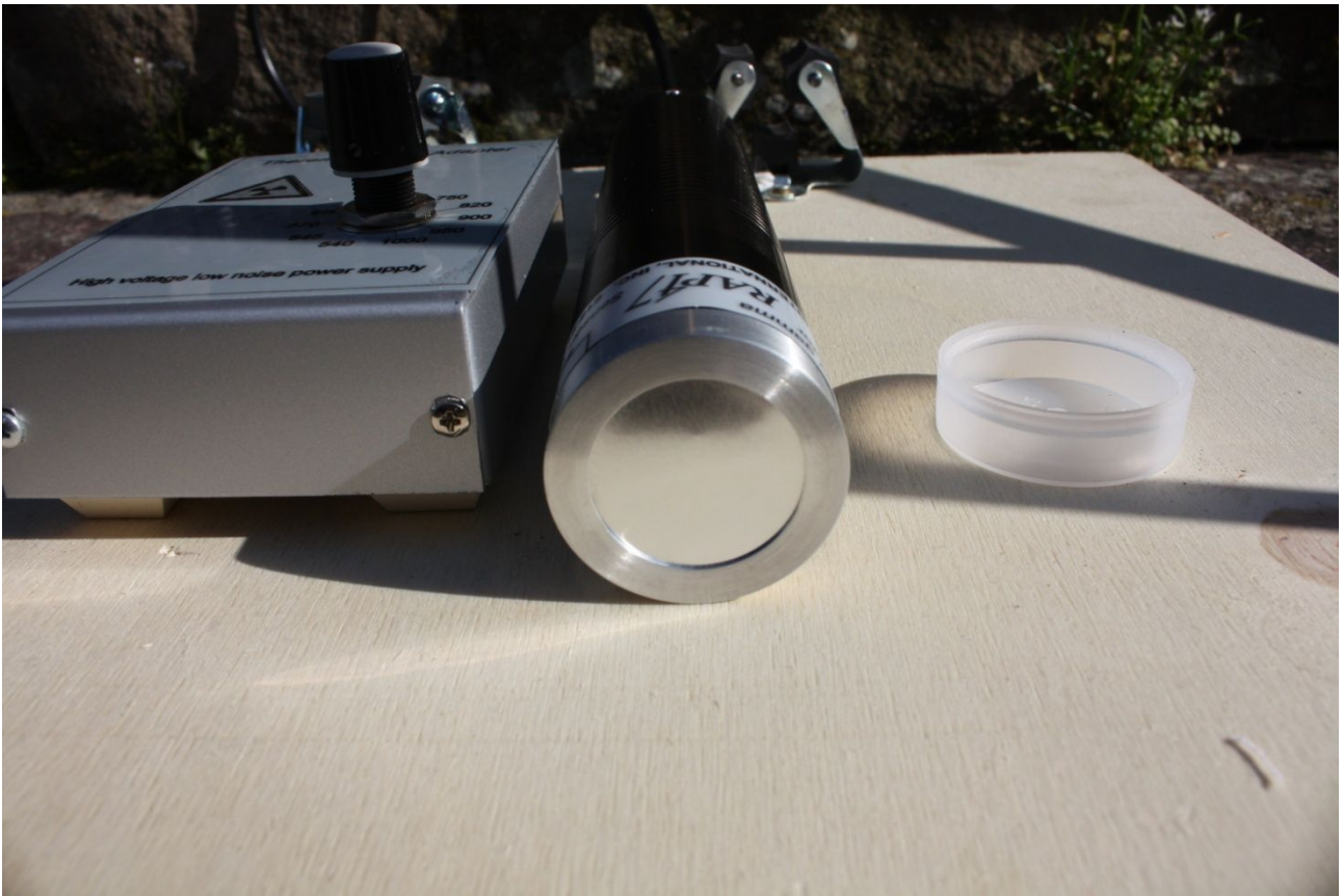
Particolare della testa, notare il sottile strato di alluminio.
