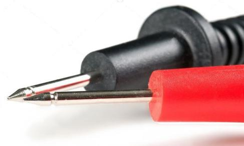
不是所有的探针都很好，例如那些在左侧具有拧开以进行维护，并且可以改变了金属箍，而在右侧上有金属熔化的塑料，并不能使用。
