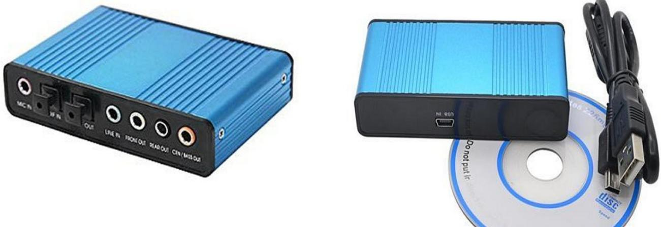
警告：包你会发现司机软盘和一张纸，上面写着你连接卡之前安装驱动程序。不这样做！我们将不使用连接器“MIC”，“SPDIF”，“REAR OUT”和“CEN / BASS OUT”，但只有“LINE IN”和“OUT FRONT”。所以，更舒适，我们发现基本的驱动程序 **USB** 音箱 它是在 Windows 10 已经存在。
