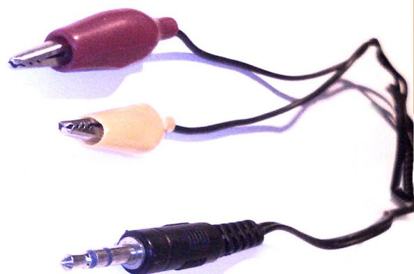
Per saldare il cavo al cocodrillo lo si spella per circa un centimetro, si eliminano i fili che fanno da schermo e lo si riveste con un tubetto termo-restringente per rinforzarlo e isolarlo, lasciando spuntare solo il filo interno. Il filo interno verrà poi saldato e ripiegato, lo si vede in colore chiaro nella immagine qui a destra.
