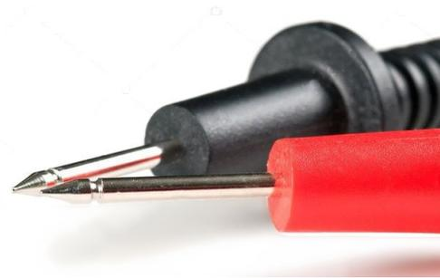
Non tutti i puntali vanno bene, ad esempio quelli a sinistra hanno il puntale in metallo che si svita per la manutenzione e si possono modificare, mentre quelli a destra hanno la plastica fusa sul metallo e non sono utilizzabili.
