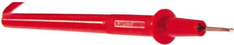
Per fare il corpo della sonda non c'è di meglio che un puntale di recupero, preso da un vecchio tester. I puntali dei tester sono progettati per circa 1000 volt massimi, ma, se si tengono le dita lontane dalla punta, si può usarli in tutta sicurezza fino ad alcune migliaia di volt.
