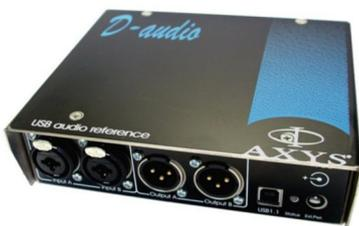
Purtroppo le schede audio non sono progettate per fare misure di tensione e quindi non lasciano passare la componente continua.
