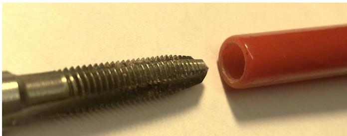
Utilizzando un maschio per filettare si prepara il fondo del puntale. A seconda del diametro del puntale si può usare un filetto per viti da 5 mm o da 6 mm.
