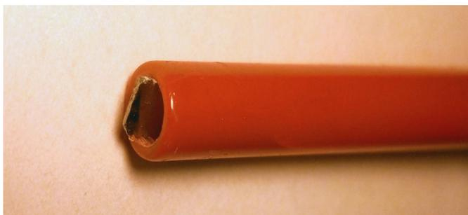
La parte a "V" permette di infilare il puntale del tester su un lato, oppure di collegare il coccodrillo del puntale della scheda audio.
