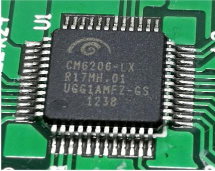
Le schede audio con il chip CM6206 hanno una tensione di polarizzazione interna di circa 1.4 volt. Il datasheet di questo chip parla di una tensione di 2.25 volt, ma tutte le schede che abbiamo provato la avevano tra 1.35 volt e 1.44 volt.
