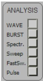
Das Bedienfeld ANALYSIS bestimmt die Grundkonfiguration des Analysators.
