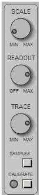
Um die Unwucht zu korrigieren, vergewissern Sie sich, dass sich die INPUT-Tastatur in STEREO befindet, dass der ANALYSE-TYP WAVE ist und dass die MIXER-Schieberegler alle auf Null abgesenkt sind, drücken Sie die CALIBRATE-Taste und warten Sie einige Sekunden.
