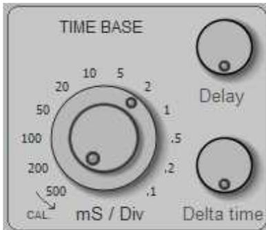
Dieses Panel ist Teil der OSZILLOSKOP-Sektion und wird nur bei WAVE- und BURST-Analysen verwendet.
