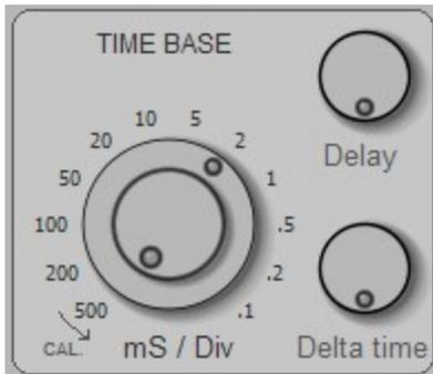
Questo pannello fa parte della sezione OSCILLOSCOPIO e si usa solo con le analisi WAVE e BURST.
