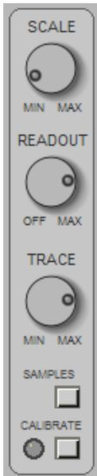
Per effettuare la correzione dello sbilanciamento assicurarsi che la tastiera INPUT sia in STEREO, che il TIPO DI ANALISI sia WAVE e che i cursori del MIXER siano tutti abbassati a zero, premere il pulsante CALIBRATE e attendere qualche secondo.
