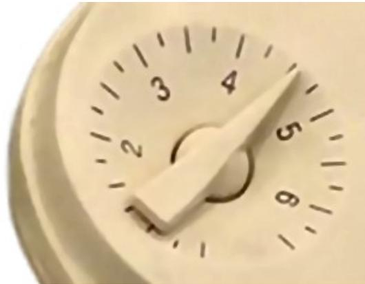
Uno dei problemi noti dello strumento originale era la necessità di azzerare frequentemente l'ago, a causa delle lente derive della resistenza del soggetto durante l'uso. Per cui la applicazione Emotion-Meter esplora un nuovo modo di rappresentare le variazioni di resistenza, visualizzandone la derivata.
