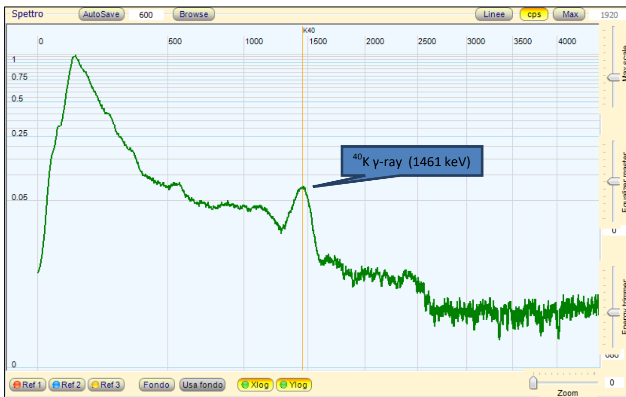
Sonda a scintillazione – Cristallo NaI(Tl) 63 x 63mm
