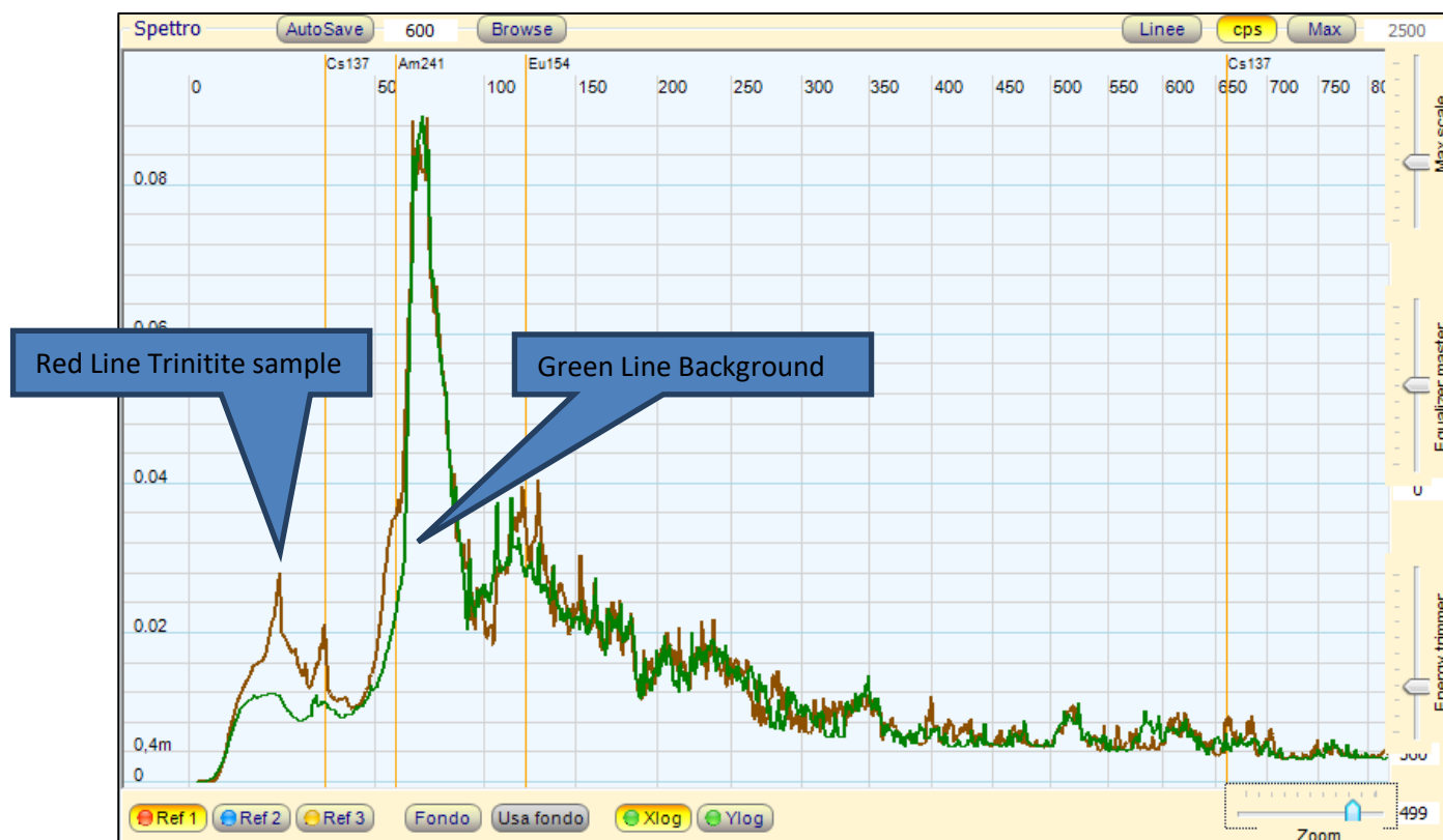
Sonda a scintillazione – Cristallo NaI(Tl) 25.4 x 25.4mm - PMT R6095 Hamamatsu – schermato
