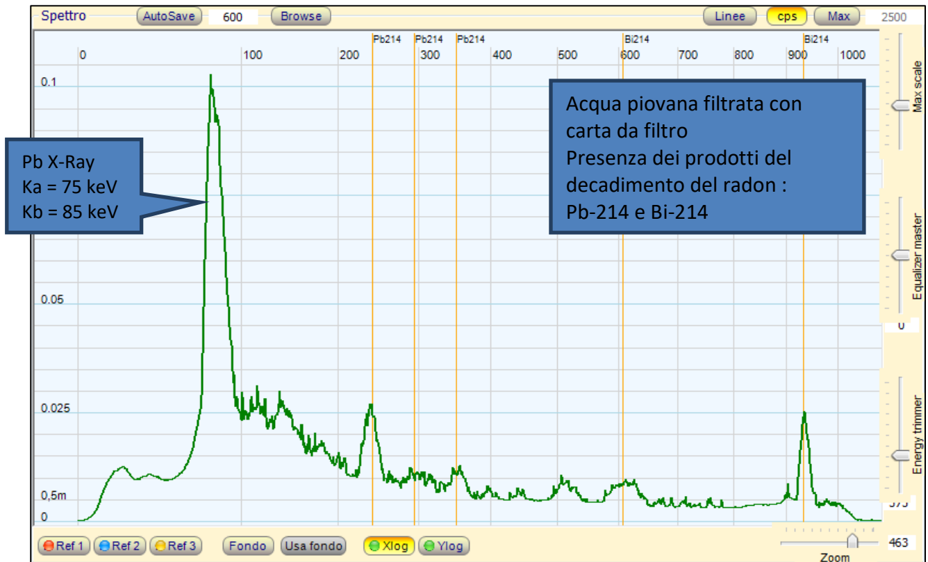
Sonda a scintillazione – Cristallo NaI(Tl) 25.4 x 25.4mm - PMT R6095 Hamamatsu - schermato
