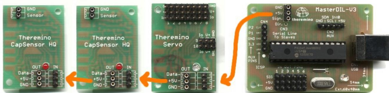
Gli slaves possono essere connessi in qualunque ordine ma se si cambia la loro disposizione o il loro numero la configurazione hardware si disallinea da quella del programma HAL
