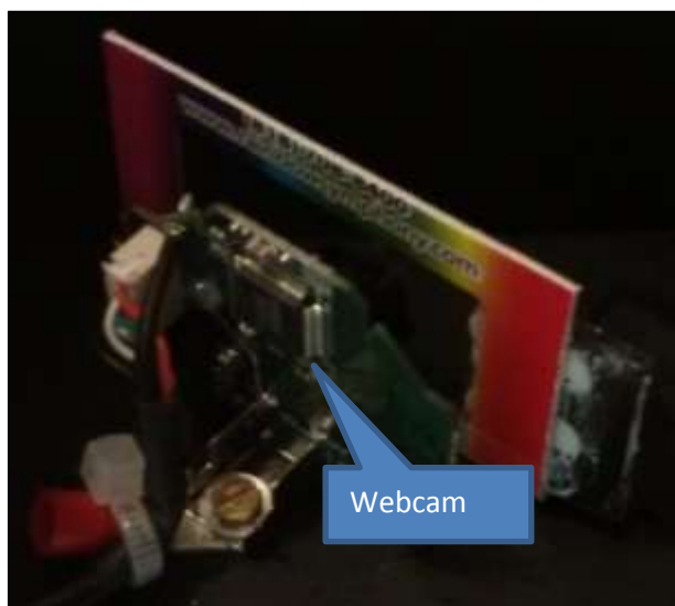
Particolare della webcam e del reticolo di diffrazione
