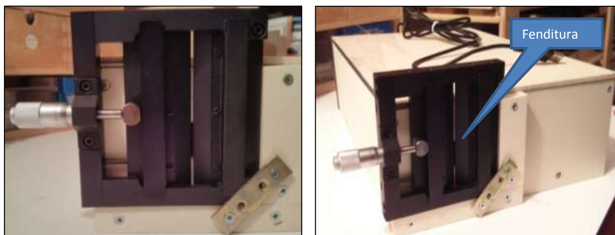
Dettaglio della fenditura micrometrica e vista dello spettrometro assemblato
