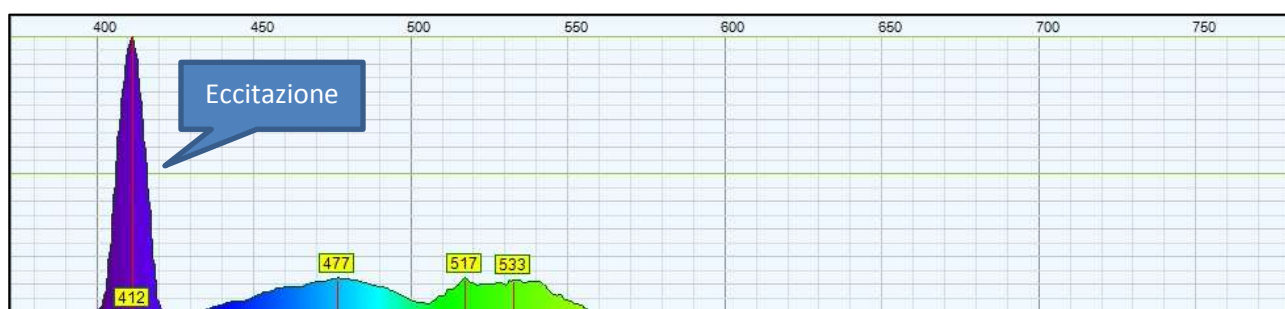
Spettro di fluorescenza del bulbo di una lampadina alogena eccitato da emissione UV.
