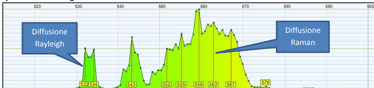
Spettro di scattering Raman di etanolo 95% - Eccitazione laser 532nm
