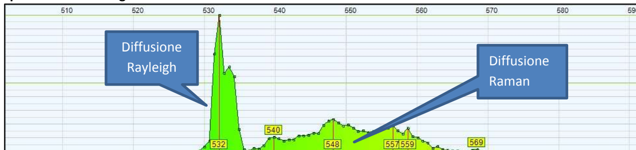
Spettro di scattering Raman di clorofilla in etanolo 95% - Eccitazione laser 532nm
