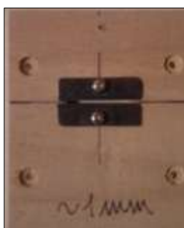
Fenditura frontale da 0,1mm, fenditura da 0,5mm e fenditura da 1mm
