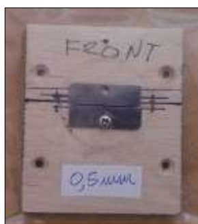
Fenditura frontale da 0,1mm, fenditura da 0,5mm e fenditura da 1mm
