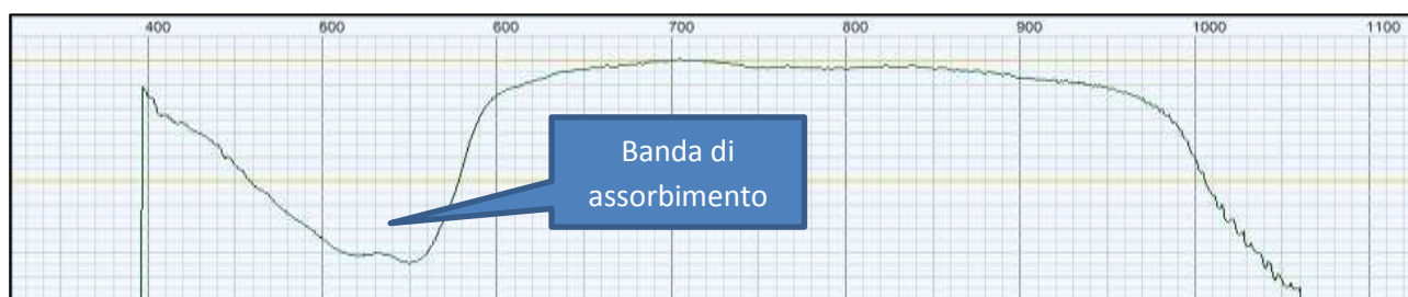
Spettro assorbimento (in trasmissione) della cobalamina.
