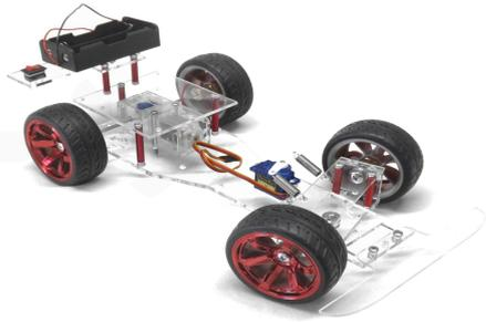
I veicoli con ruote sterzanti sono i più facili da guidare, si imposta il controllo come X/Y e vanno dritti facilmente.
