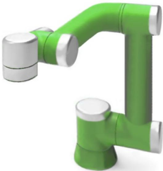
La sicurezza di un Cobot deve essere intrinseca. La meccanica stessa non deve disporre di forza e di velocità in grado di fare del male.
