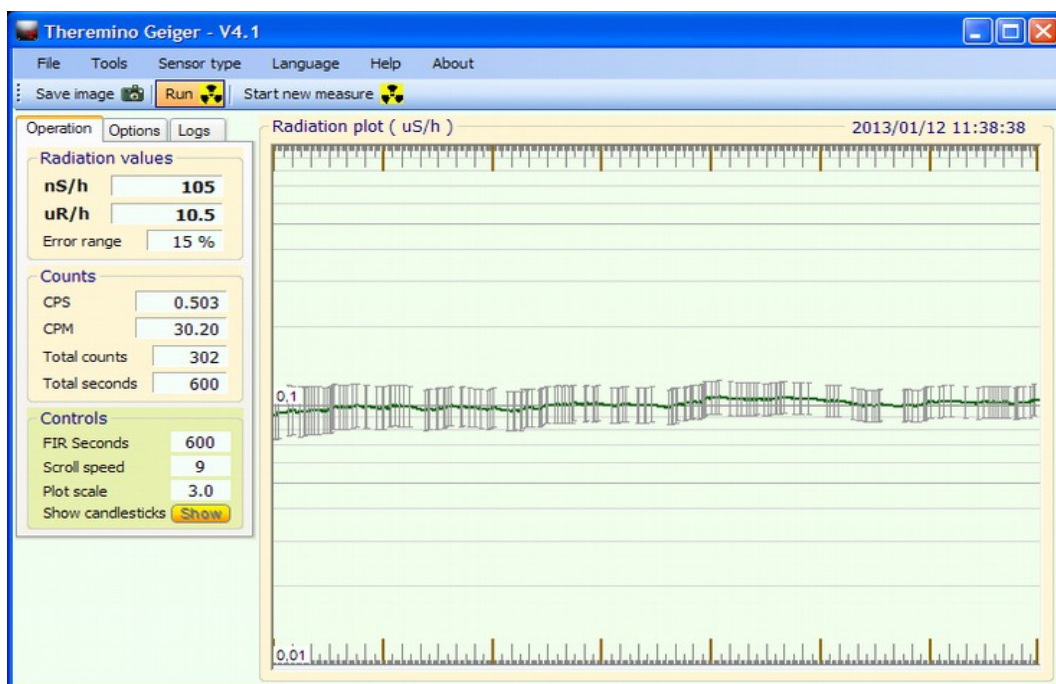
Fondo ambiente con un tubo SBM-20 e filtro FIR impostato a 600 secondi
