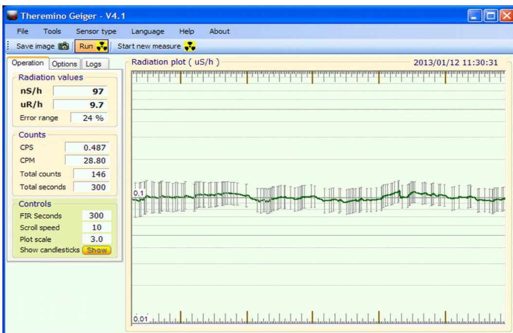
Fondo ambiente con un tubo SBM-20 e filtro FIR impostato a 300 secondi
