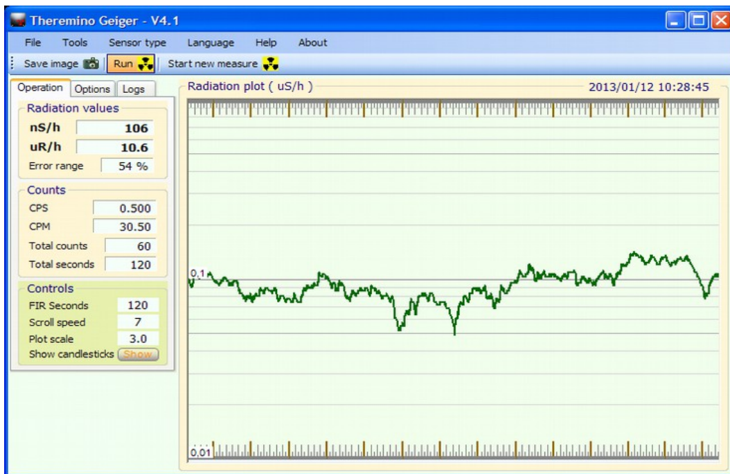
Fondo ambiente con un tubo SBM-20 e filtro FIR impostato a 120 secondi
