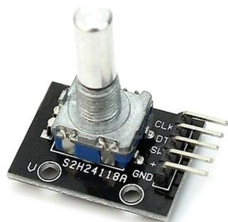
Esistono Encoder simili a piccoli potenziometri (i più noti sono i KY-040 di questa immagine). Questi modelli sono meccanici e forniscono 18, 20 o 24 impulsi per giro a seconda del costruttore. Il firmware ricava da questi impulsi 72, 80 o 96 posizioni angolari per ogni giro, se regolato nel modo software (x2), oppure 36, 40 o 48, se regolato nel modo hardware (x4).
