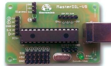
Con la applicazione [lotHAL](#) si configurano i Pin di ingresso uscita, per leggere sensori, muovere motori ecc..
