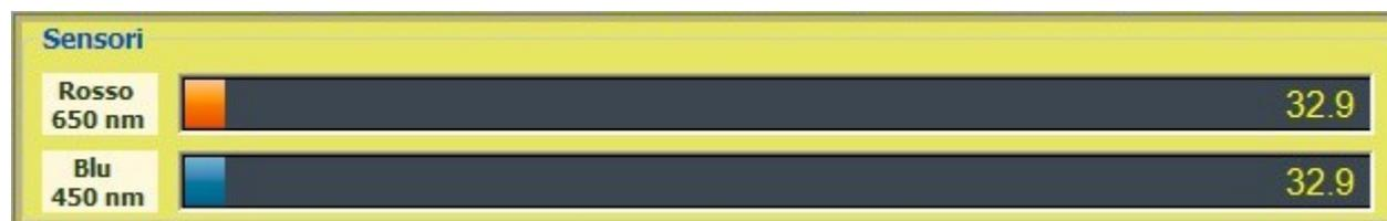
Questo pannello indica continuamente i valori misurati dai fotodiodi sensori per la luce rossa (650-700 nm) e blu (400-500 nm)
