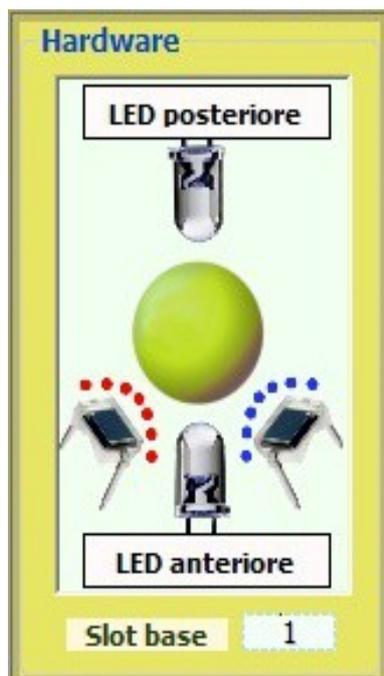
I comandi di questo pannello permettono di fare test manuali per controllare e mettere a punto il dispositivo di misura. Durante i test automatici i bottoni e i led si illuminano per indicare le varie fasi della misura. I due componenti racchiusi con i filtri rossi e blu tratteggiati indicano la posizione approssimativa dei fotodiodi di misurazione delle componenti di luce rossa (650-700 nm) e blu (400-500 nm)
