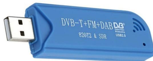
Esistono anche modelli più costosi (da 25 a 50 Euro), con quarzo che rende la **frequenza di ricezione perfettamente stabile.** Con questi modelli si ricevono le trasmissioni SSB, senza mai ritoccare la frequenza.
