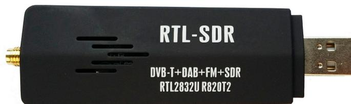
Il nuovo **RTL-SDR V3** contiene due importanti miglioramenti. (1) Può ricevere le onde corte (fino a 500 KHz) anche senza up-converter e con prestazioni leggermente inferiori ma paragonabili. (2) Può alimentare la antenna attiva (aggiungendo 3 componenti). Leggere le note nella [pagina di download](#) di Theremino SDR.
