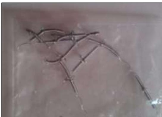
Campione XRF: Resistenze in tungsteno
