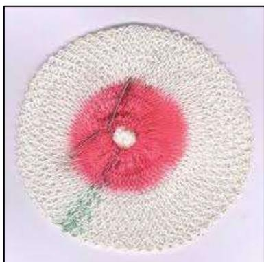
**Campione XRF: Reticella lampada a gas del nuovo tipo**
