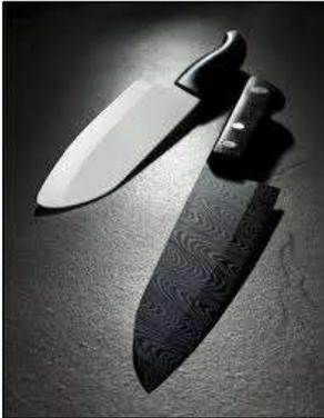
Campione XRF: Lama in biossido di zirconio
