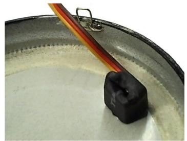
Inserire un pezzo di guaina termo-restringente, scaldarlo con l'accendino o ancora meglio con una pistola ad aria calda o con un Phon modificato (con un tubo di uscita metallico per ridurre le dimensioni del flusso di aria in uscita).
