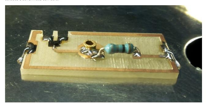
Il modulo del FET (come tutti gli altri moduli) viene fissato per mezzo di due fili nudi saldati alla base in lamiera stagnata o ricoperta di nastro di rame adesivo. Questo modulo viene poi coperto con uno schermo in latta (lamierino di ferro stagnato) e il coperchio viene saldato sui due lati.
