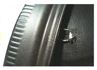
Se manca parte della schermatura anche i test di rumore sul TP3 con l'oscilloscopio non saranno significativi e si vedrà una forte ondulazione alla frequenza di rete (20 mS di ciclo pari a 50Hz).
