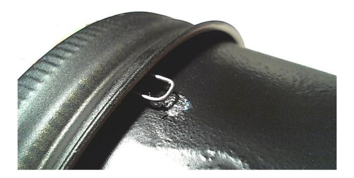
Prima di fare i test elettrici, si deve collegare il coperchio inferiore. Si consiglia di saldare tutte le ancorette del primo coperchio superiore e di saldarne almeno una per ognuno degli altri due.
