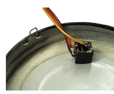
Accorciare i terminali della presa jack femmina con le tronchesine, stagnarli bene e infine saldare i tre fili alla presa. Controllare che il filo marrone sia collegato alla base, il filo rosso al polo centrale e il filo giallo alla punta del jack. Eventualmente inserire un jack e controllare con il tester.
