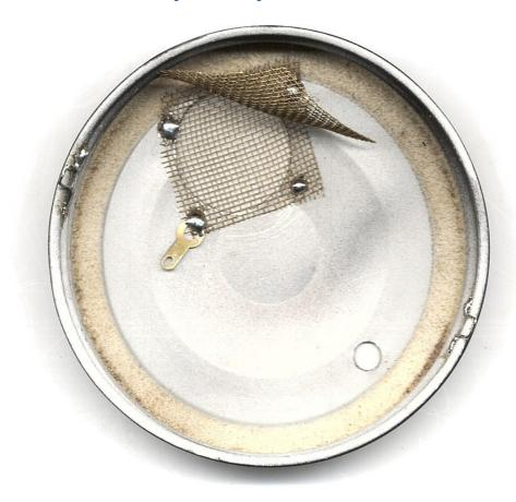
I filtri per la polvere sono due, sui fori dei due coperchi esterni. Ecco un modo semplice ed efficace per fissarli. Si salda un secondo quadretto di reticella di ottone, su un solo angolo. Sull'angolo opposto si salda una piastrina metallica o un pezzetto di filo rigido. In questo modo il filtro potrà essere messo e tolto facilmente. Si posiziona il filtro stando attenti a coprire bene il foro e si ripiega la piastrina per fissarlo.
